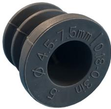
推入式孔环用于不带RJ-45连接器的电缆。该孔环适用于单根圆形电缆, 不适用于扁平或变形电缆。
